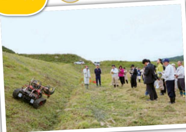
▲斜面を走行する試作機。刈刃の上下運動や角度調整もリモコンで操作します
