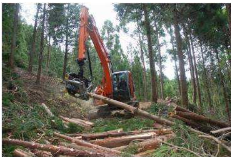
森林作業道上でのプロセッサによる造材作業
