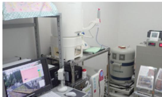
村でも水道水の放射性物質を測定しています。
