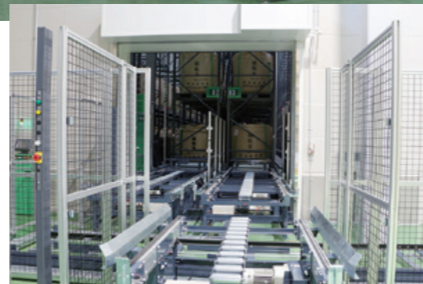
自動ラック式低温倉庫。1tの米袋を自動収容します
