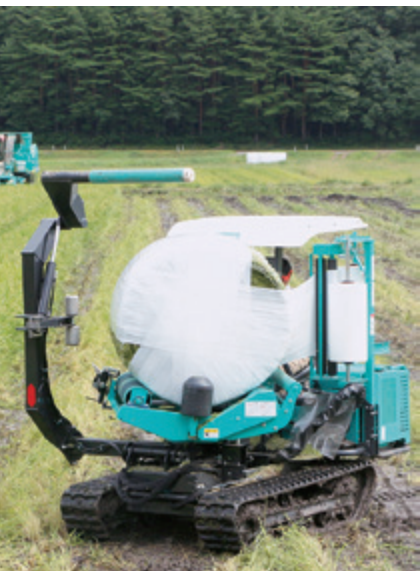
汚れを避けるためシートを敷いた上に排出されるロールを、小型重機が持ち上げグルグルグル。あっという間にラップ材が巻かれていきます。
